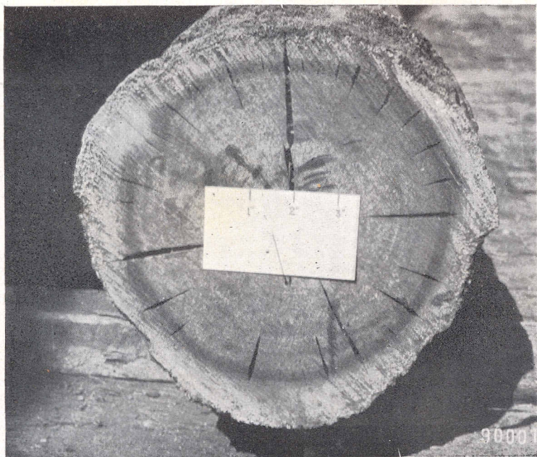
Fig. 67 — Estaca de E. globulus , retirada da bahia de S. Francisco depois de 10 annos de uso. Esteve collocada ao lado da estaca de «Douglas Fir».
